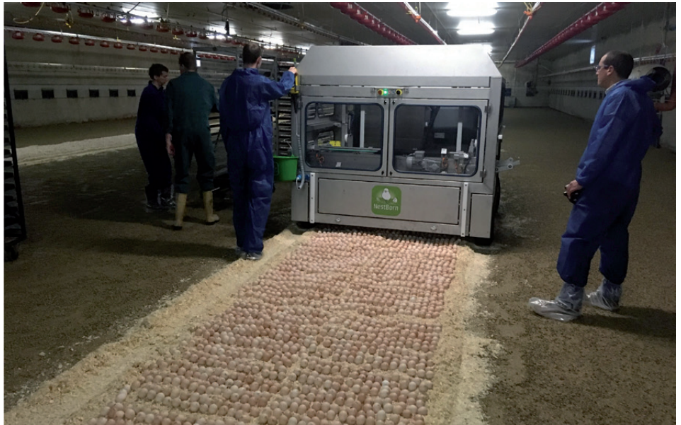
Der Lege-Roboter von NestBorn legt die Eier gleichmäßig in die Sägespäne ab. Quelle: Thomas Wengenroth
