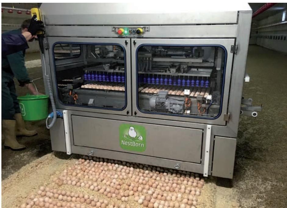
Der Lege-Roboter von NestBorn legt die Eier gleichmäßig in die Sägespäne ab. Quelle: Thomas Wengenroth
