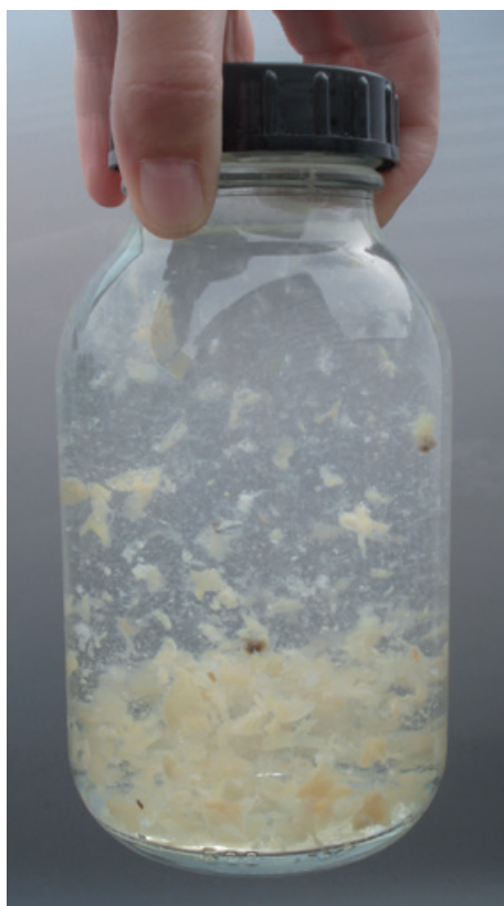
Abb. 3: Wasserprobe aus dem Stall. Deutlich sind Flocken vom Biofilm in der Wasserprobe zu erkennen. Quelle: Dr. Pia Münster
