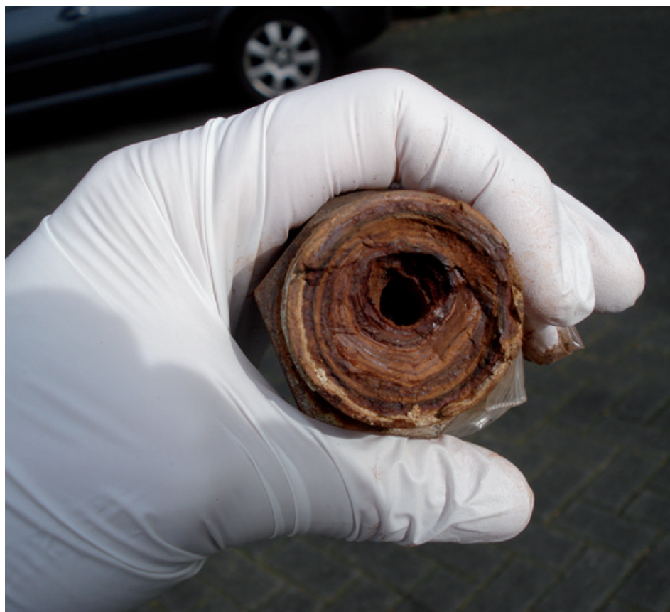
Abb. 1: Ablagerung von Metallen (Inkrustierungen)
