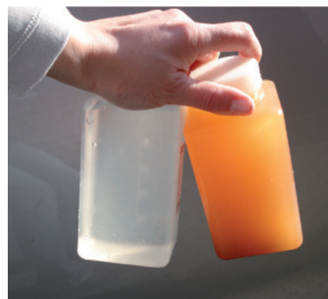
Abb. 2: Die Wasserqualität kann sich im Laufe der Prozessschritte verändern. Wasserprobe links (Anfang der Wasserleitung); Wasserprobe rechts (Ende der Wasserleitung).
