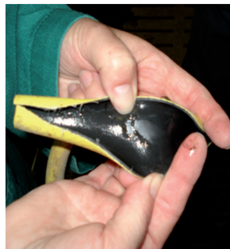
Abb. 5: Vor allem Materialien mit viel Weichmacher begünstigen das Wachstum von Mikroorganismen. Im „Gartenschlauch“ kann nach Aufschneiden ein schleimiger Biofilm festgestellt werden.
