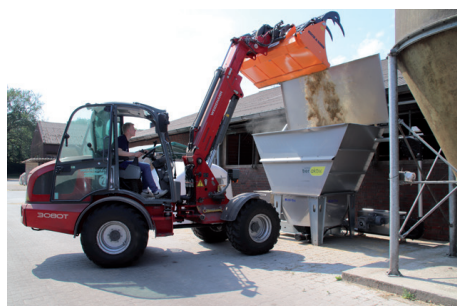
Die Befüllung des Vorratsbehälters geschieht mit dem Radlader. Quelle: Engels
