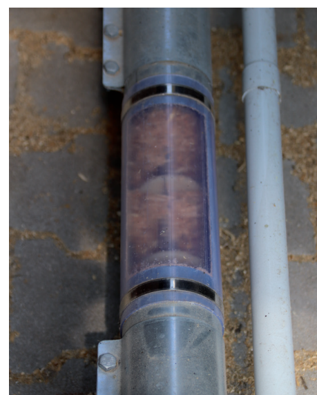
Eine Rohrketten befördert die Einstreu in den Stall. Quelle: Engels
