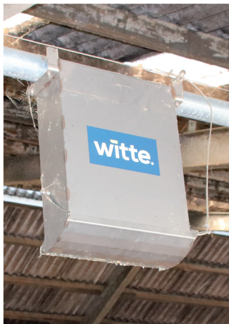
Aus diesem Kasten rieselt die Einstreu direkt in die Box. Quelle: Engels
