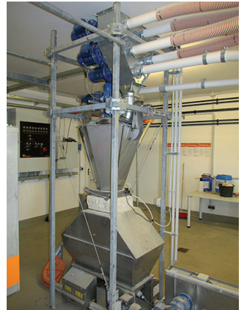
Mit einem Chargenmischer und mehreren Silos kann sehr einfach auf eine mehrphasige Fütterung umgestellt werden. Quelle: Gerd Hermeling
